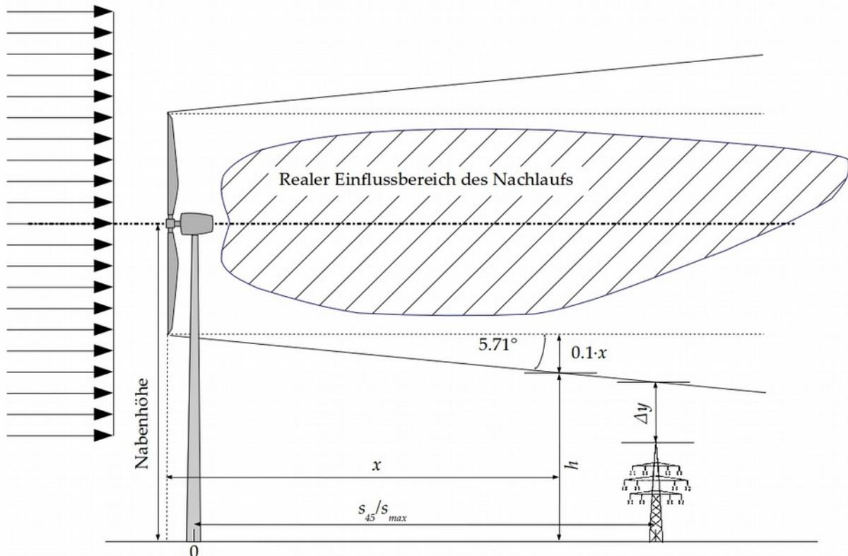
**Abbildung 2.3.1:** Vereinfachtes Verfahren zur Abschätzung des schädigenden Einflussbereichs der Nachlaufströmung nach [1] und beispielhafter realer Einflussbereich (gestreift) auf Basis von CFD-Berechnungen.
